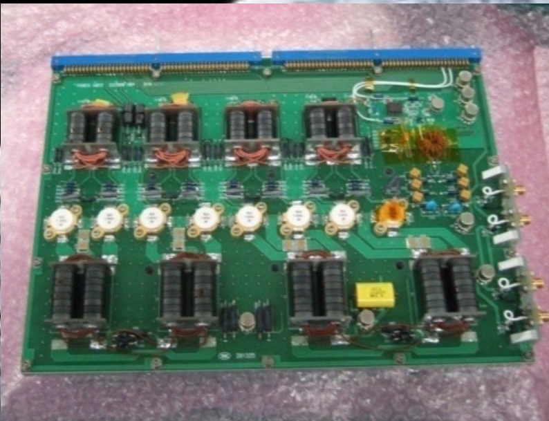
月レーダサウンダー送信部の基板
